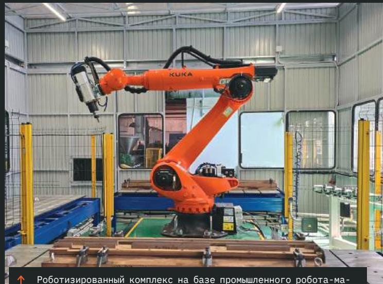
↑ Роботизированный комплекс на базе промышленного робота-манипулятора с магазином инструментов и поворотным столом для обработки крупногабаритных изделий сложной формы
