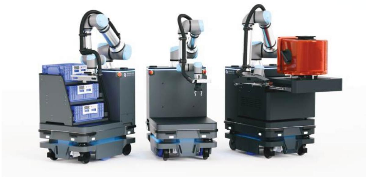
↑ Гибридные конфигурации мобильного робота и кобота
