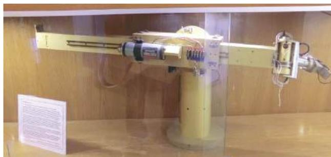
Stanford Arm – первый прототип промышленного робота с электроприводом осей
